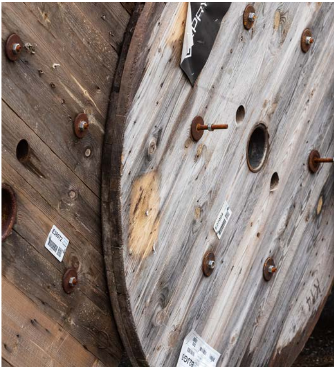
E Bojātas vai iztrūkstošas saivas metāla detaļas.
